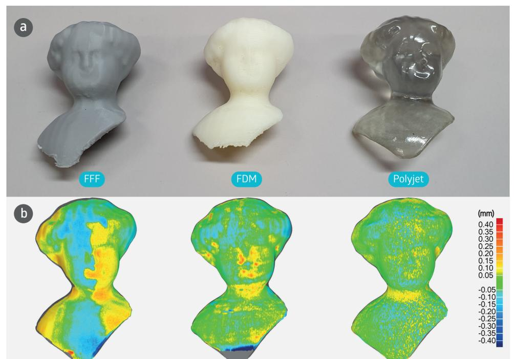
Figura 3 - Cabeça de boneca: a) peças impressas e b) análise dimensional.
