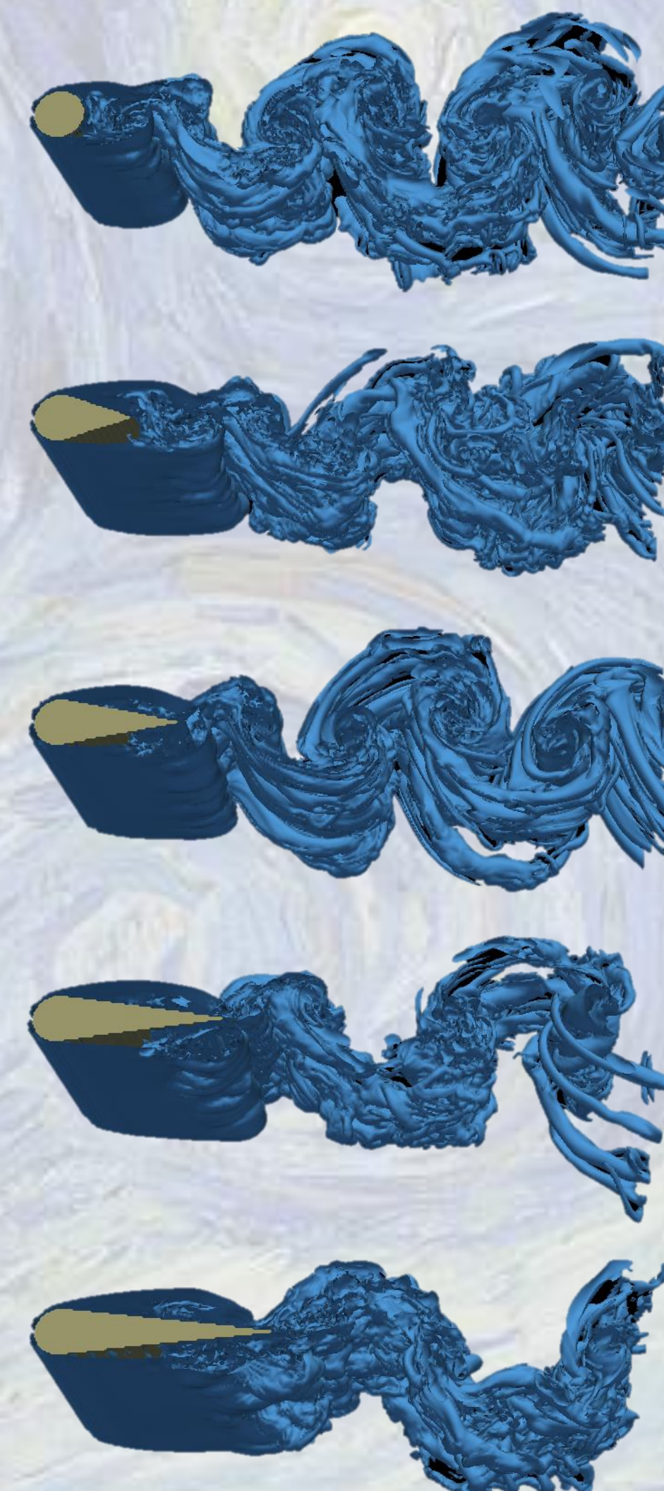
Fig. 5 – Campos de vorticidade de um cilindro sem e com carenagem ( L/D = 1, 2, 3 e 4 ). Re = 1250 .
