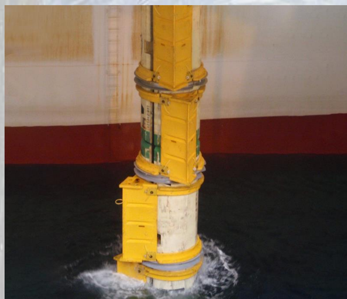
Fig. 1 – Carenagens (amarelo) em um riser . Fonte: https://www.jamstec.go.jp
