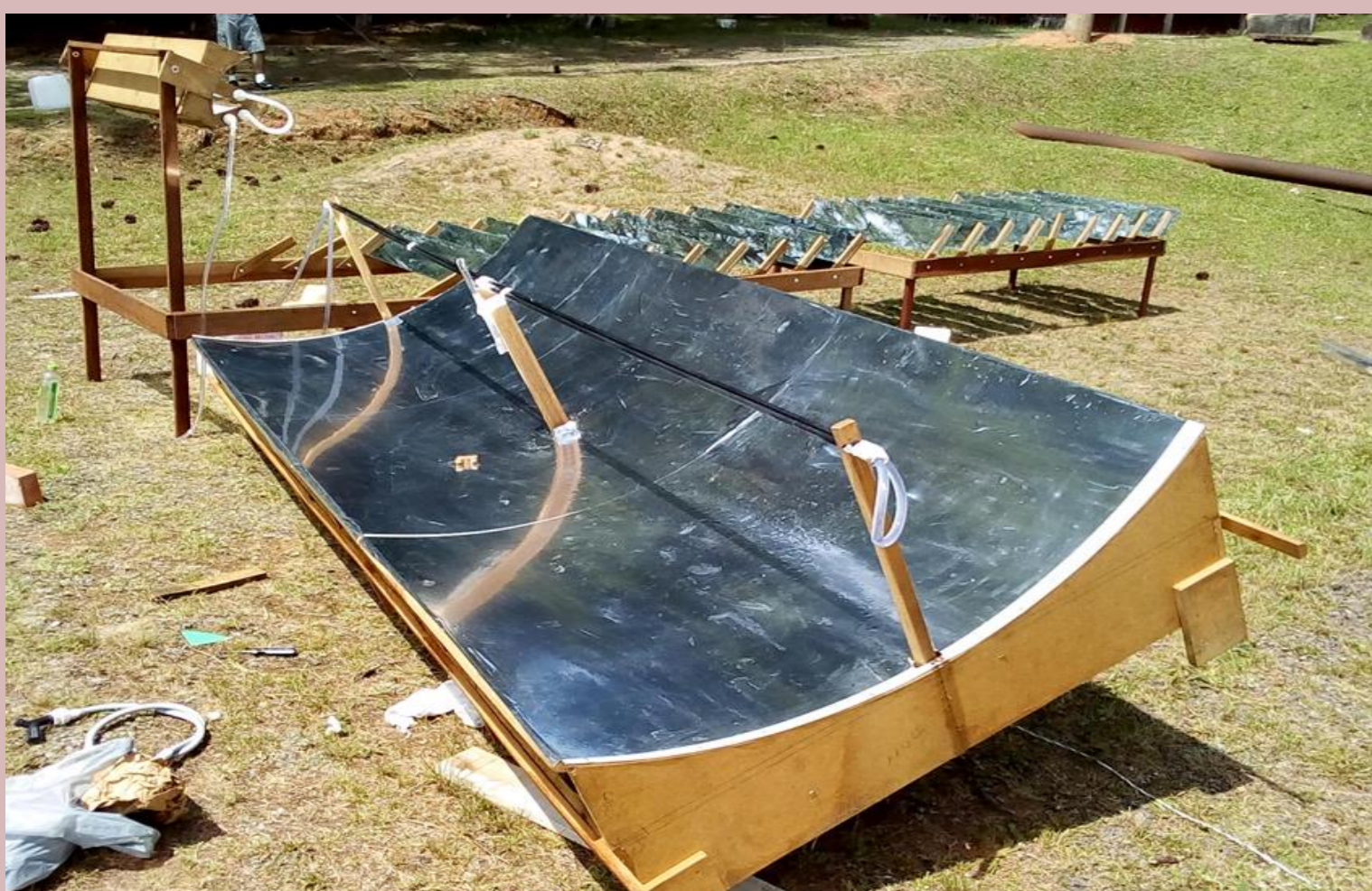
figura 1: Foto do protótipo do sistema SODIS em uso, aquecedor de água à direita e concentrador de UVA e UVB à esquerda.
