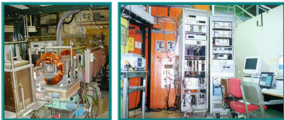
Figura 7.2 – O filtro montado a partir do protótipo de Brookhaven (esquerda) e os equipamentos de controle e monitoração (direita), na execução do primeiro experimento, no instrumento POSY I ( Intense Pulsed Neutron Source – Argonne National Laboratory ).
