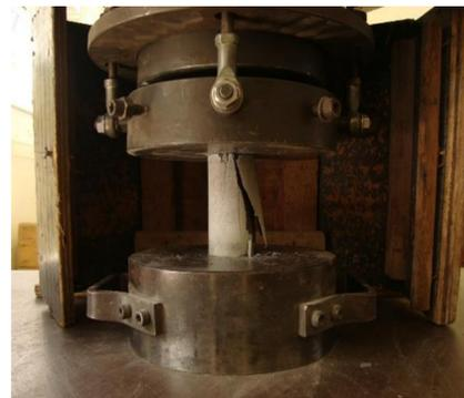
Figura: Ensaio de compressão simples
