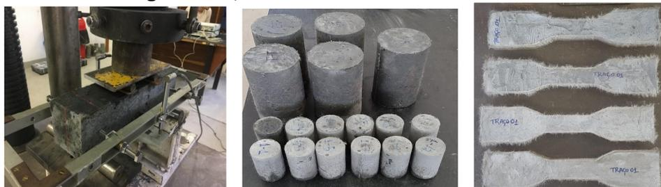
Figura: Ensaio de flexão de quatro pontos, CP's para os ensaios de compressão simples e módulo de elasticidade, CP's para ensaio de tração
