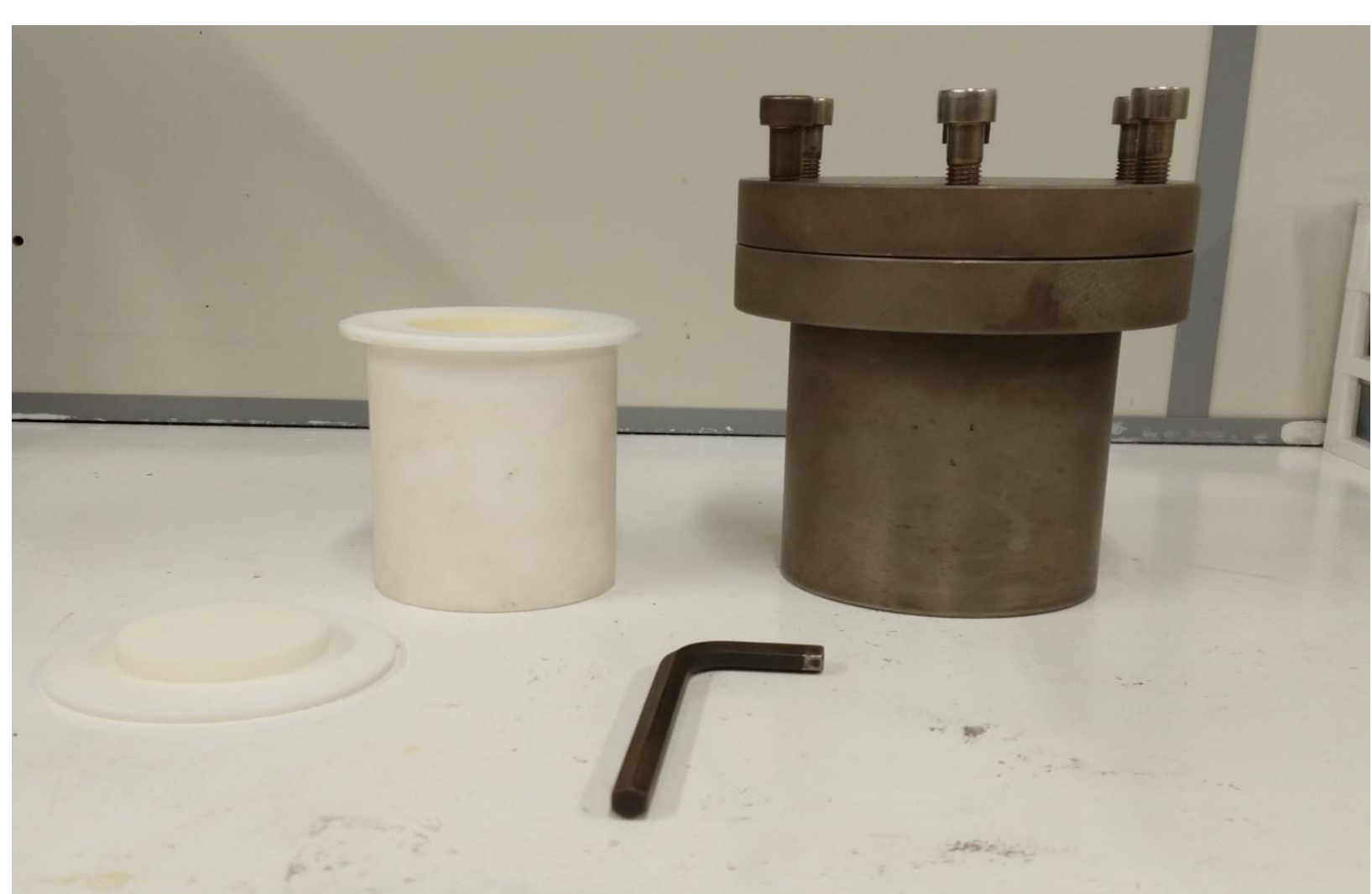
Figura 1: Reactores de Teflon e Aço Inox. Após preparadas as soluções, estas são colocadas primeiramente no reator de teflon e depois no reator de aço. Foram colocadas então em uma reação hidrotermal a 150°C por 10h.
