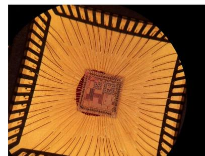
Fig. 2: Visualização do chip no microscópio : foto dos uPADS onde é depositado as microponteiras para a execução das medições.
