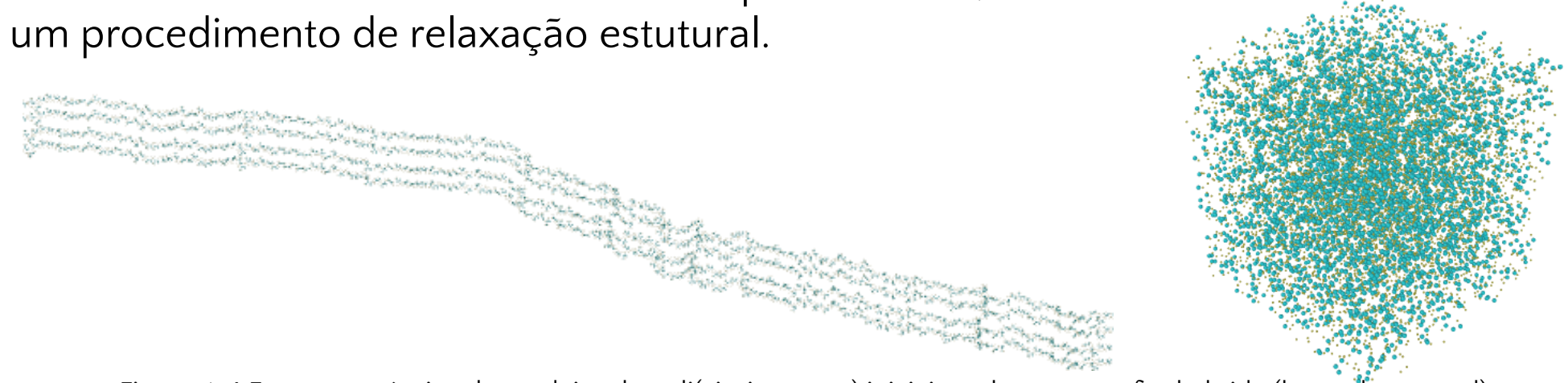
Figura 1: 4 Estrutura atômica das cadeias de poli(cis-isopreno) iniciais, e da estrutura final obtida (borracha natural).
