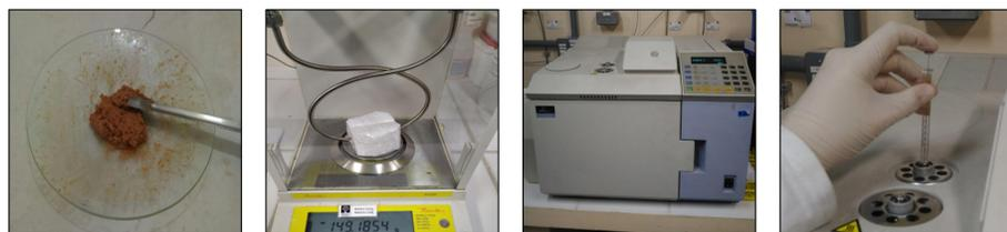
Figura 1: (a) recheio da coluna; (b) coluna preenchida; (c) cromatógrafo gasoso durante condicionamento; (d) injeção da amostra.
