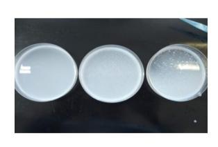
Teste de Estabilidade ao Álcool Solução alcoólica com concentração de álcool que variam de 68 a 82°GL com intervalo de 2°GL
