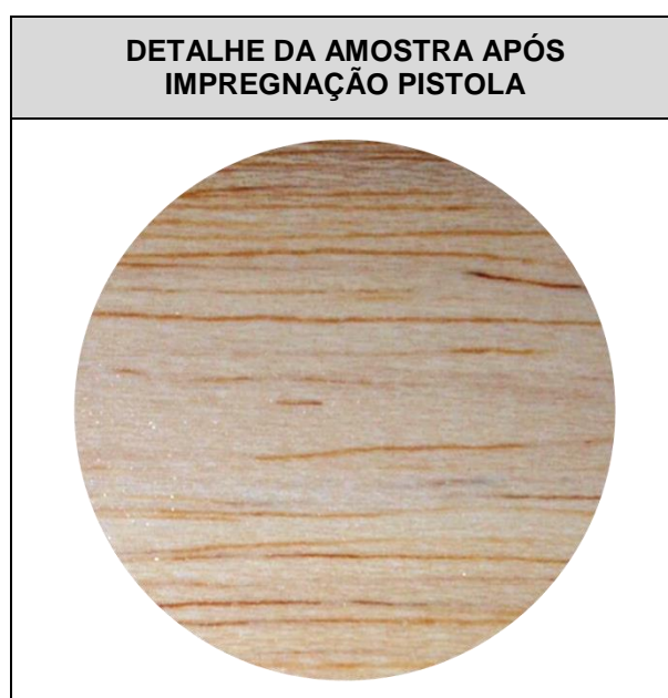
Figura 56– Impregnação Carreador Lipídico Nanoestruturado (CLN). Detalhe da amostra após impregnação
