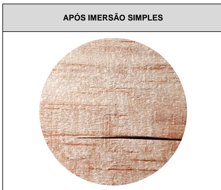
Figura 36 – Teste 2 (amostras de 5 cm x 5 cm), após imersão sem adição de resina (fenda da madeira já existente no suporte)
