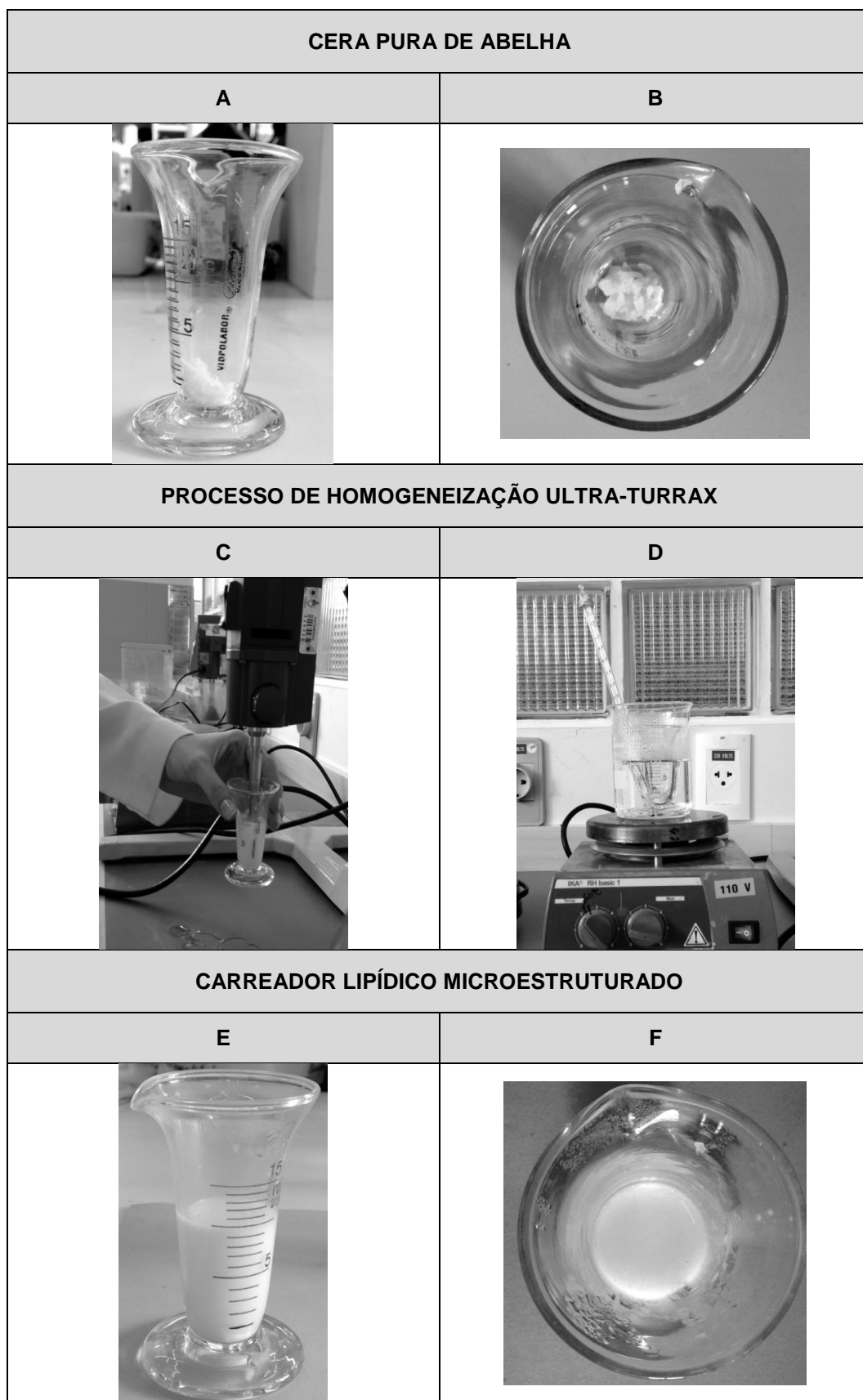
Figura 45 – Mostra o processo do Teste 2, cera pura de abelha (A e B), processo de homogeneização Ultra-Turrax (C e D), resultado do Carreador Lipídico Microestruturado
