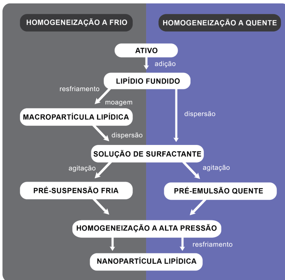
Figura 19 – Processo de produção de Nanopartículas Lipídicas que utilizam frio e quente com a técnica de homogeneização em alta pressão
