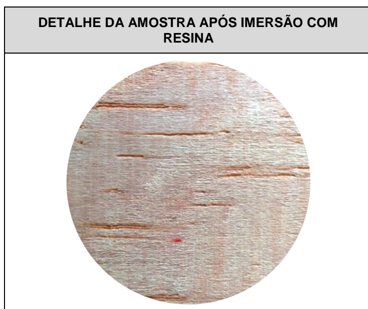
Figura 40 – Teste 4 amostra (5cm x 5cm) (foto detalhe após imersão de microcápsulas com adição de resina (38g)
