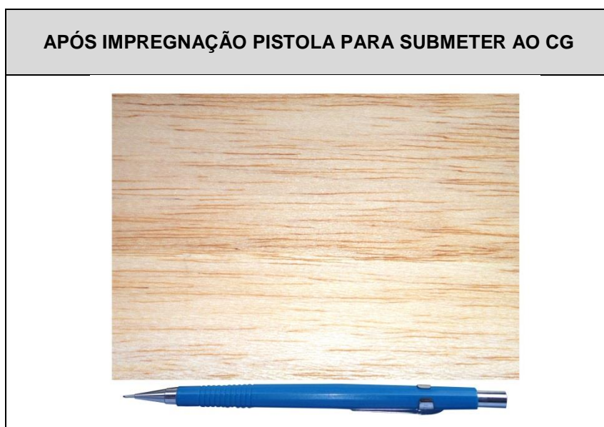
Figura 58 – Amostra submetida ao teste de cromatografia à gás (CG). Fotografia após impregnação
