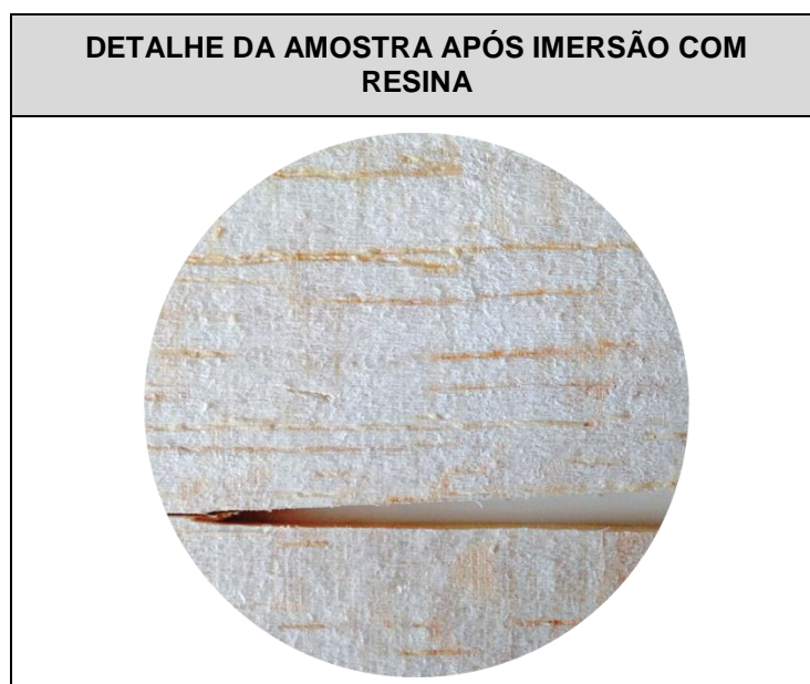
Figura 42 – Teste 5 (foto após imersão) amostras com adição de resina (76g)
