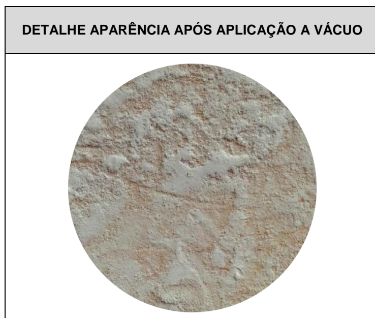
Figura 34 – Teste 1 (impregnação sem adição de resina) Presença de pó branco na superfície da madeira
