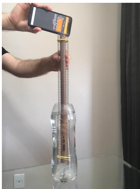
Figura 4 - Arranjo experimental do experimento utilizado em aula. Submerso em determinado nível, com o alto-falante na extremidade superior emitindo uma determinada frequência, é formada uma onda estacionária em seu interior, facilmente identificável quando o som tem um pico de intensidade.
