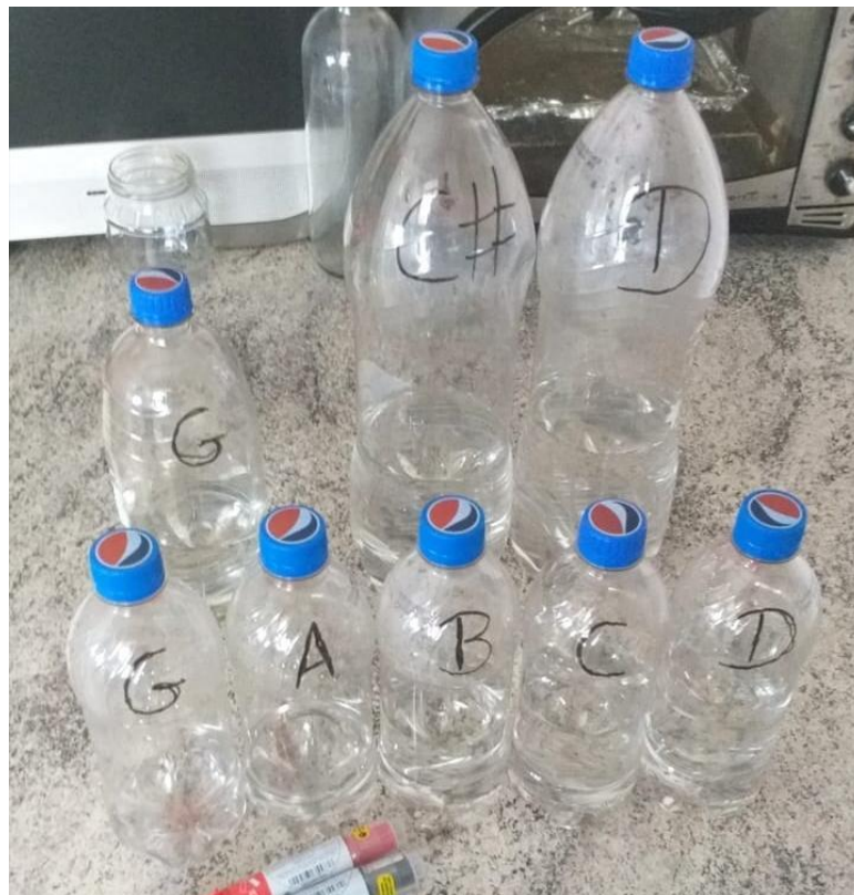
Figura 5 - Garrafas enchidas com água para emitir uma nota. As garrafas estão com a indicação da nota que emitem. G, A, B, C, D e C# são símbolos para as notas Sol, Lá, Si, Dó, Ré e Dó sustenido, respectivamente.
