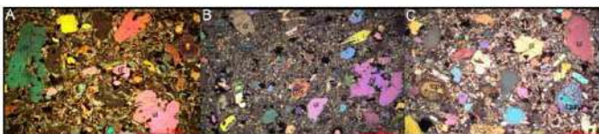
Figura 2. Fotomicrografia das amostras de nefelinito mostrando fenocristais de clinopiroxênio e olivina, e microfenocristais de titanomagnetita. Fotos A e B a nicóis cruzados, C a nicóis paralelos.
