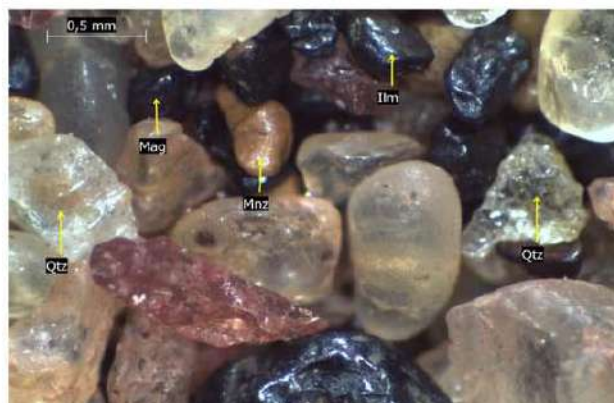
Figura 2: Imagem oblíqua em lupa binocular (aumento 35 x) das areias monazíticas que constituem a amostra P3GRPA2, com destaque para as ocorrências de Monazita (Mnz), Quartzo (Qtz), Magnetita (Mag) e ilmenita (Ilm).
