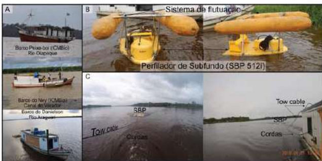
Figura 2. Materiais utilizados para a coleta dos dados sísmicos: A) embarcações utilizadas em cada campanha, B) vistas frontal e lateral do sistema de perfilagem sísmica SBP512i, com os flutuadores montados, e C) perfilador sísmico rebocado pelo barco do Danielex, no Rio Araguari.
