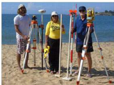
Figura 3. Equipamentos empregados, da esquerda para a direita: nível topográfico, GPS-RTK, balizas de Emery, Estação Total. A direita: Praia de Camburi em Vitória - ES, com localização dos perfis de nivelamento topográfico.
