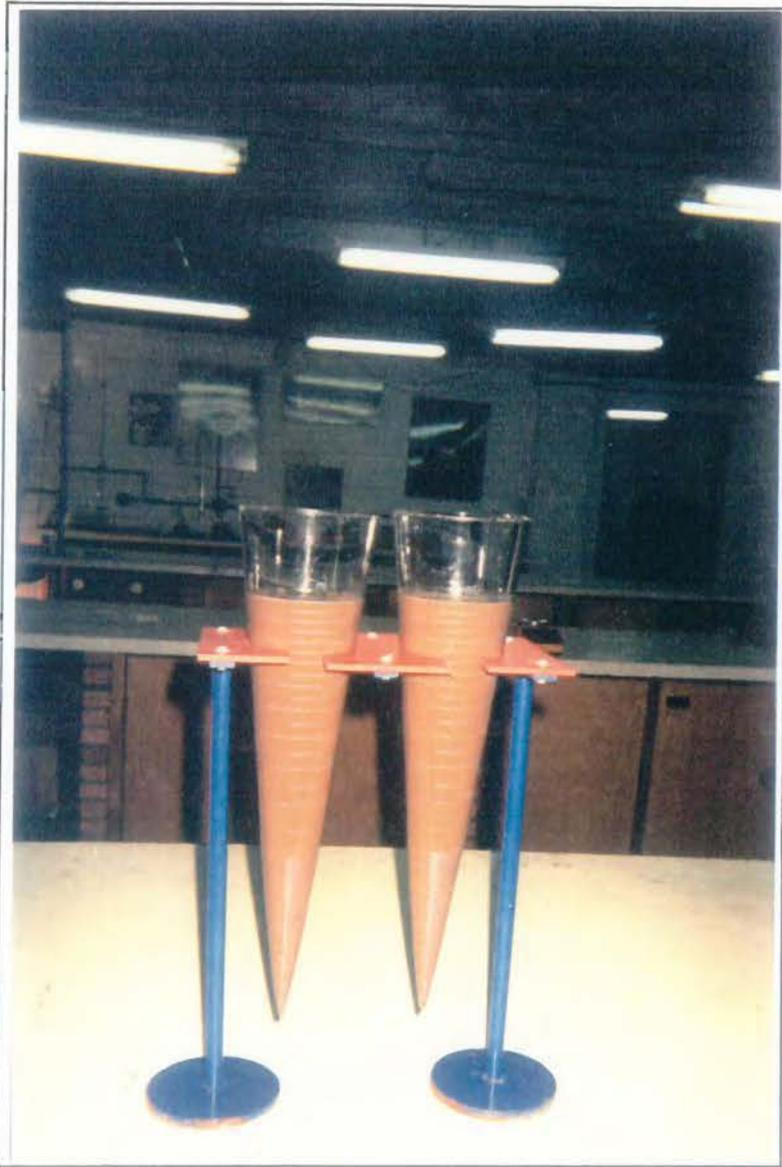
Figura 5.8 – Ensaio de sólidos sedimentáveis em Cone Imhoff (ao lado)
