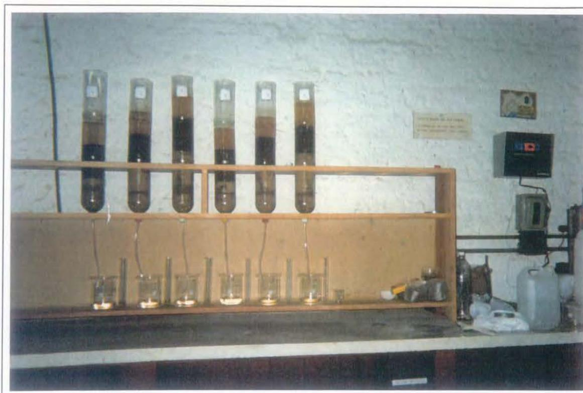
Figura 5.3 – Desidratação do lodo novo em leitos de secagem com meio drenante/filtrante de areia
