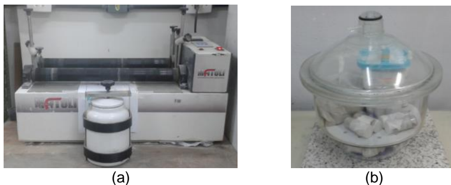
Figura 33 – Equipamento utilizado na Fase 1. (a) Moinho de bolas com esferas de ágata; (b) Dessecadora vácuo para armazenamento e conservação das amostras
