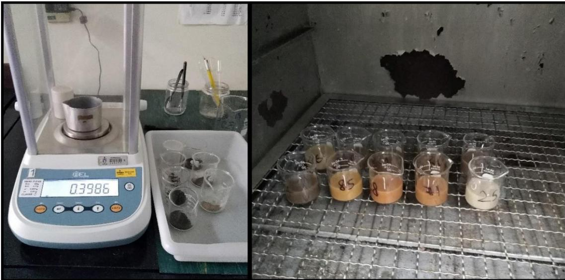
*Figura 13 - Pesagem (esquerda) e secagem de finos (direita)*
