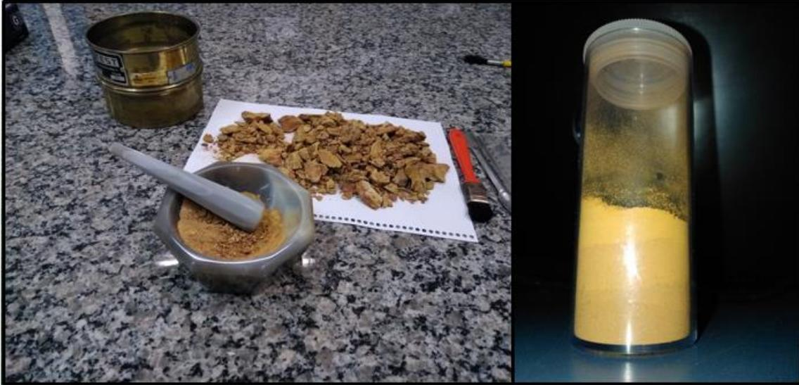
*Figura 14 - Preparação de amostras para análise por DRX e FRX.*
