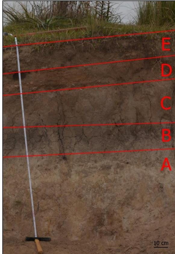
*Figura 5 - Perfil 1 com as 5 subdivisões realizadas (à direita a denominação das amostras coletadas); a trena mostra espessura de 1,40m*
