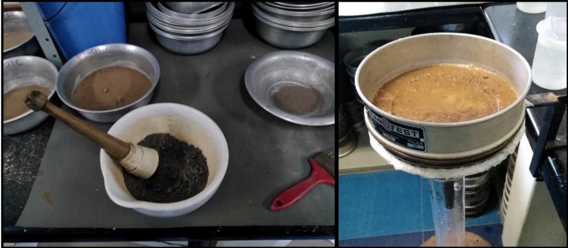
Figura 12 - Cominuição de sedimentos (à esquerda) e filtração em peneira de 0,062mm (à direita)
