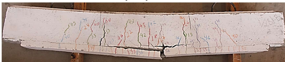
Figura 59. Descolamento do reforço da viga V3c-28d-B observado na continuação do ensaio após ruptura inicial.
