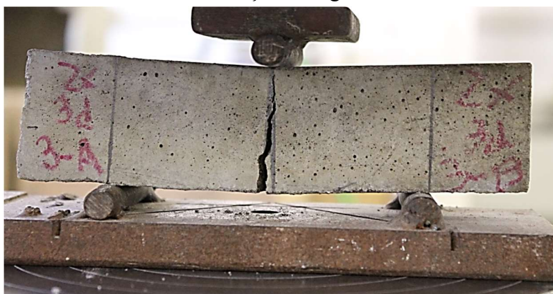
Figura 52. Ruptura típica observada nos corpos de prova prismáticos da caracterização da argamassa.
