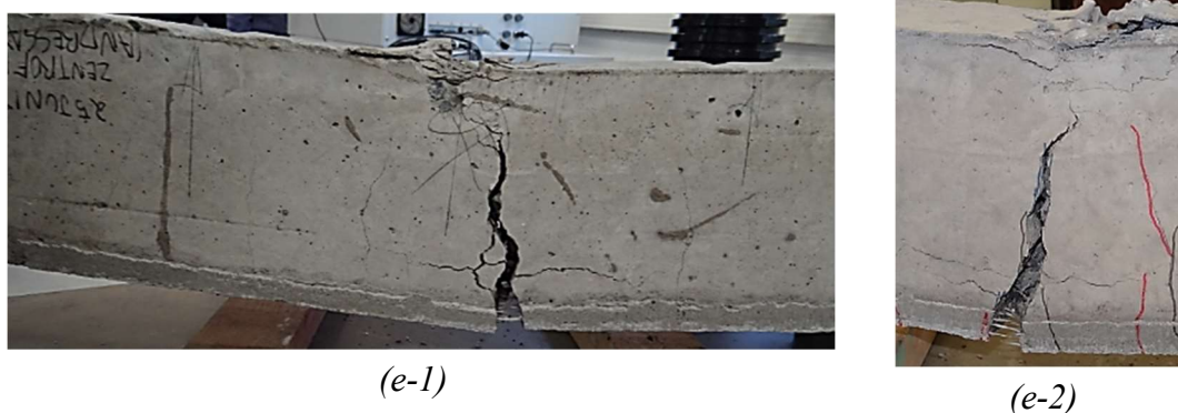
Figura 45. Registro das vigas logo após atingir a carga máxima do ensaio: testemunho (a-1 e a-2); V3c-Sk (b-1 a b-3); V3c-Zx (c-1 a c-3); e V3c-Zx-Anc (d-1 e d-2). Viga V3c-Zx-Anc levada até o colapso completo após ruptura do reforço (e-1 e e-2).
