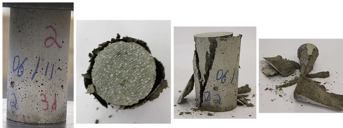
Figura 50. Ruptura típica observada nos corpos de prova cilíndricos da caracterização da argamassa.
