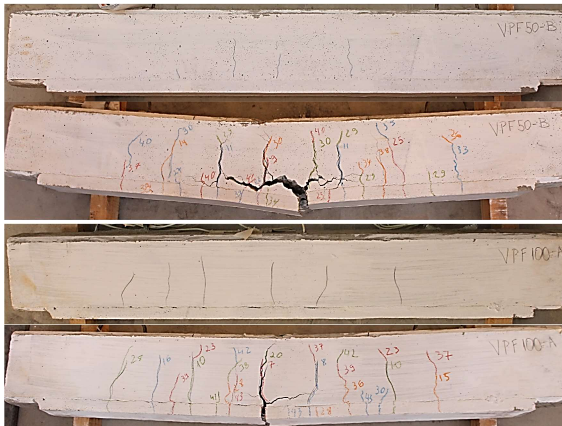
Figura 66. Viga V PF 50 B e V PF 100 A após a pré-fissuração e após o ensaio de flexão.
