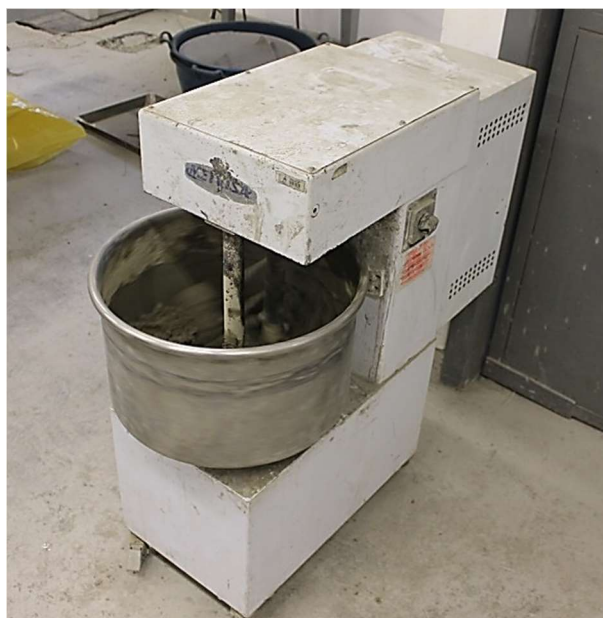
Figura 35. Amassadeira utilizada no preparo da argamassa.
