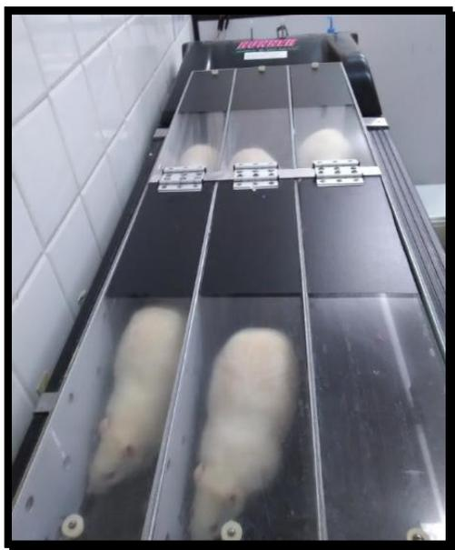
Figura 2: Fotografia da esteira ergométrica adaptada para uso em ratos. Note a presença de ratos Wistar adultos nos compartimentos individuais da esteira.
