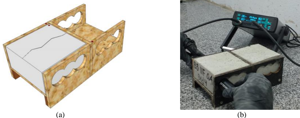
Figura 27 – Ensaio de velocidade de pulso ultrassônico com análise direta (a) representação gráfica de aparato com prisma inserido e orientação demarcada; (b) registro fotográfico do desenvolvimento do ensaio
