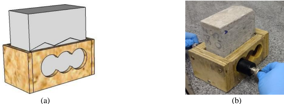
Figura 28 – Ensaio de velocidade de pulso ultrassônico com análise direta na parte íntegra (a) representação gráfica de aparato com prisma inserido; (b) registro fotográfico do desenvolvimento do ensaio
