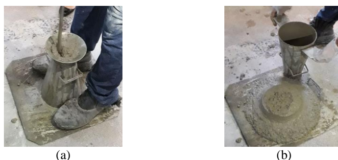
Figura 20 – Ensaio de abatimento pelo tronco de cone (a) execução; (b) aspecto visual do concreto fresco
