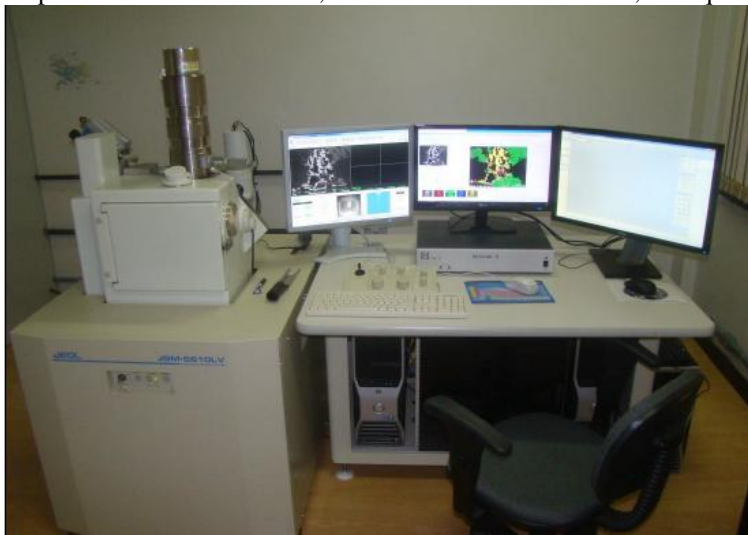
Figura 8: Microscópio Eletrônico de varredura, modelo JEOL JSM-6610LV, CPGq - IGEO - UFRGS.
