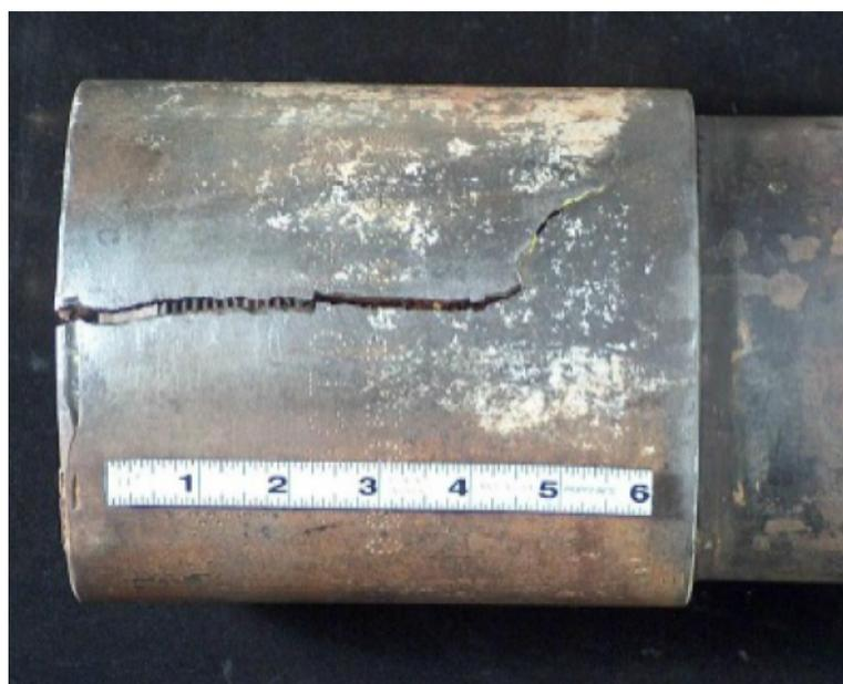
**Figura 3.** Trinca em acoplamento de série P110. Adaptado de [4].
