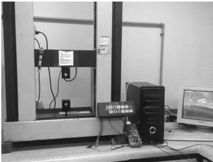
**Figura 72.** Máquina de tração utilizada para obtenção de curvas tensão-deformação.
