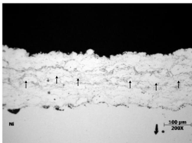
**Figura 13.** Revestimento de níquel aplicado por HVOF. Regiões cinza mostram oxidação formada durante aplicação do revestimento [72].
