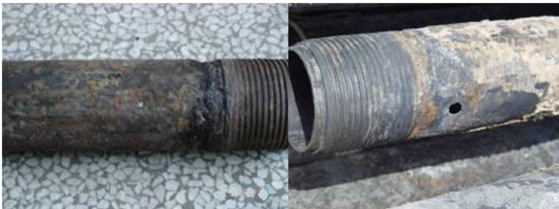
**Figura 2.** Ataque corrosivo em tubulação de aço da série P110. Adaptado de [3].
