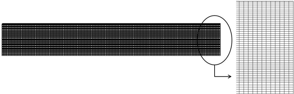
Figura 6.1- Malha com 48 \times 140 volumes utilizada nos cálculos [Adaptada de Centeno, 2014].
