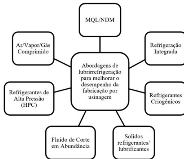
Figura 2.24 – Principais métodos de lubrificação aplicados durante o processo de usinagem [adaptada de Sharma et al., 2009].
