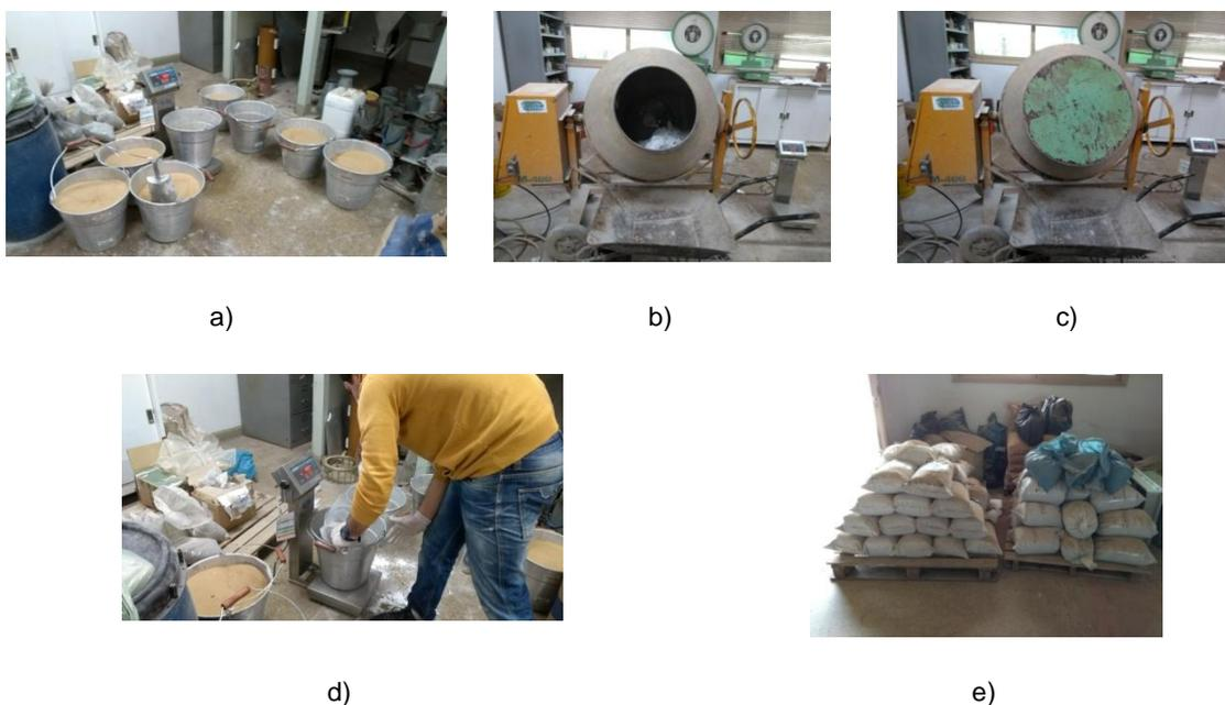
Figura 24: sequência de dosagem dos traços das argamassas de projeção; a) preparação dos materiais, colocação dos materiais na betoneira, homogeneização dos materiais, d) material sendo pesado e ensacado, e) acondicionamento em paletes de madeira
