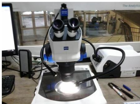
Figura 18: lupa estereoscópica com câmera digital acoplada, pertencente ao Laboratório de Materiais e Tecnologia do Ambiente Construído (LAMTAC) do NORIE/UFRGS
