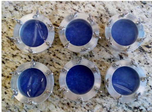
Figura 11 - Amostras de silicone fixadas nas células de permeação de alumínio preenchidas com sílica seca para teste de permeabilidade a vapor de água.
