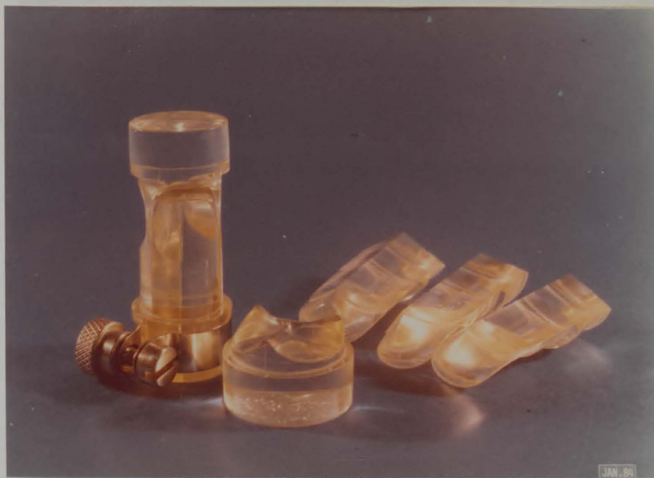
Figura 4 - Módulos de acrílico com braçadeira metálica, para ajuste da dura-máter no anel metálico
