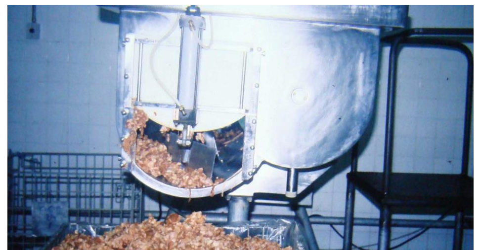
FIGURA 13.21: Separador de gordura.
