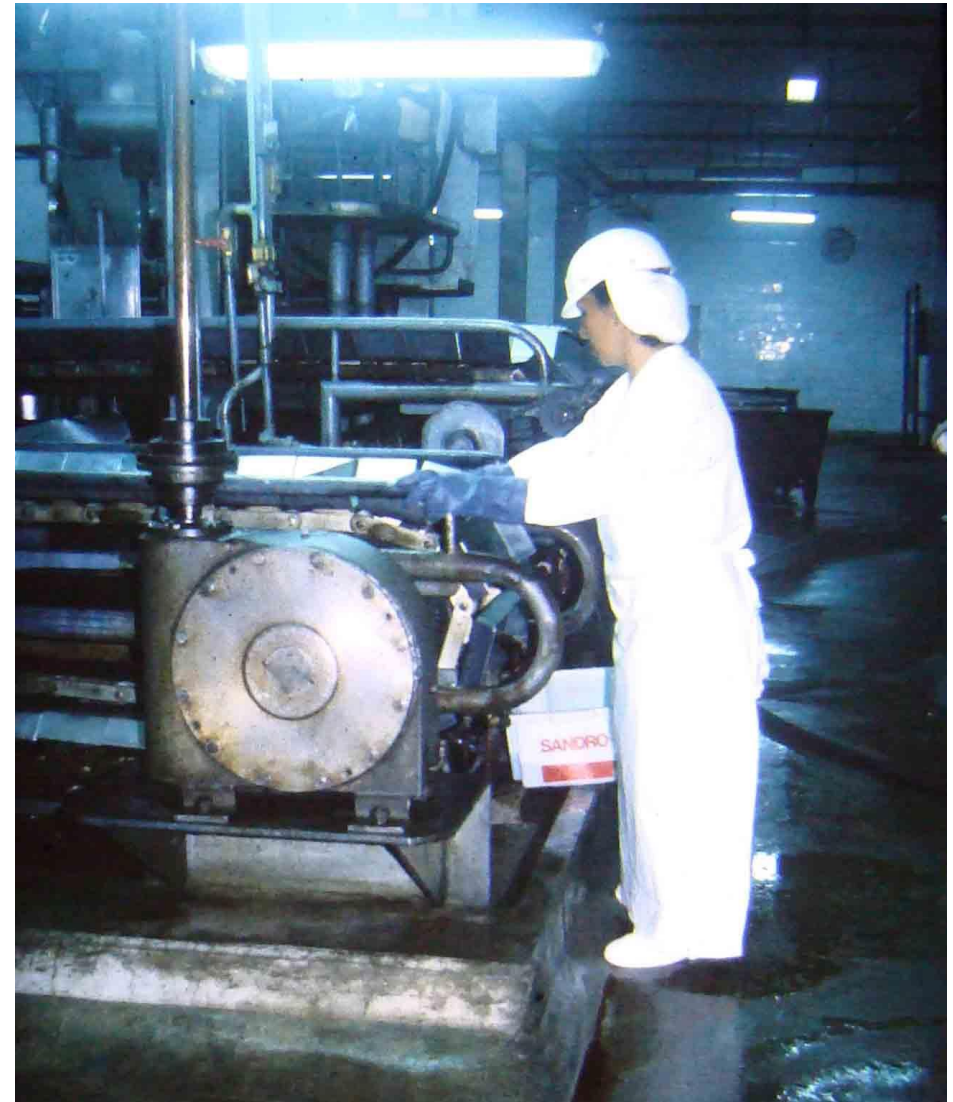
FIGURA 13.29: Limpeza dos moedores, setor de sub-produtos.
