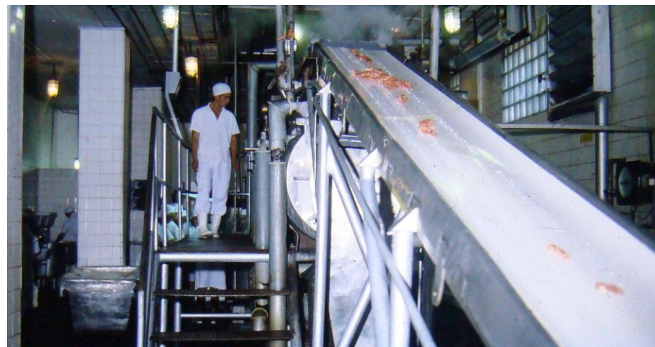
FIGURA 13.22: Túnel de cozimento contínuo.
