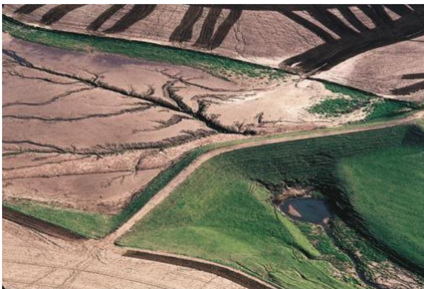
Figura 1: Represa totalmente assoreada e sem sua função original de amortecimento de cheias em Iowa, Estados Unidos (Fonte: adaptado de Healy et al. (1989)).
