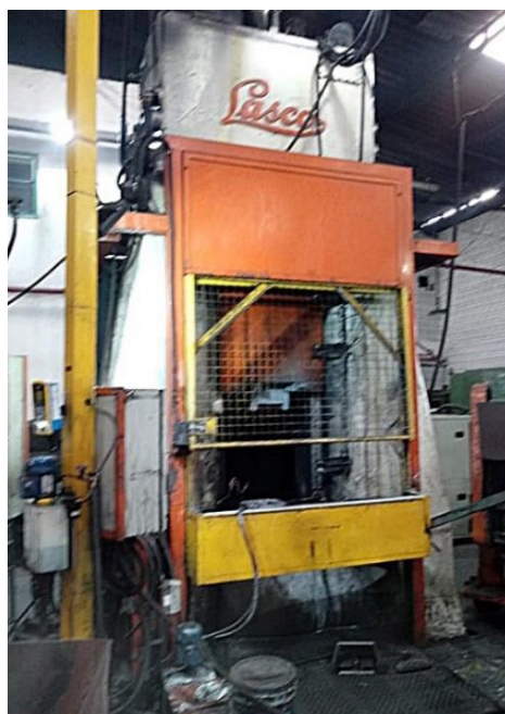
Figura 27 – Equipamento Martelo de queda utilizado no processo de forjamento da peça em estudo.
