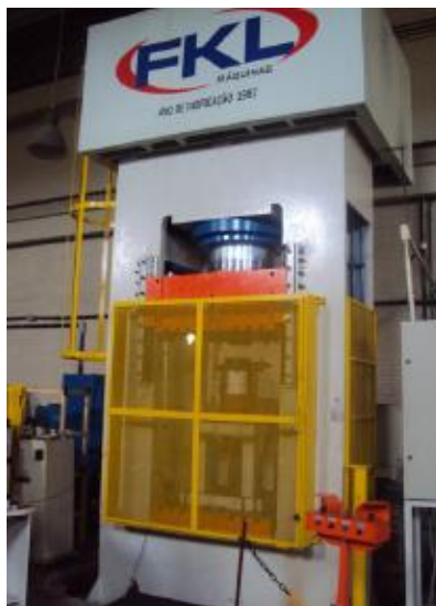
Figura 14 – Prensa FKL utilizada nos ensaios de determinação do coeficiente de atrito.
