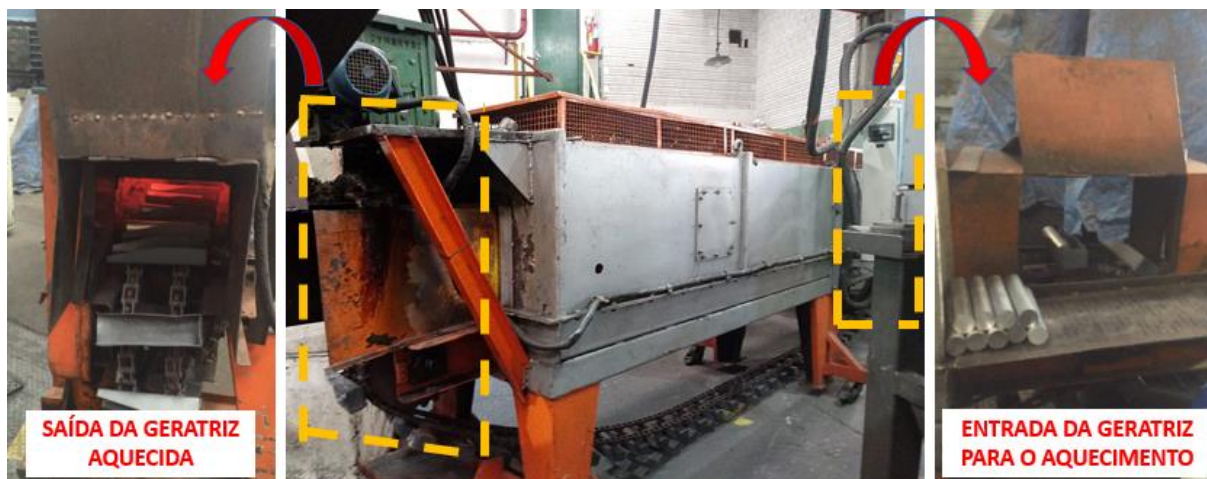
Figura 26 – Forno resistivo utilizado para aquecimento da geratriz no processo.
