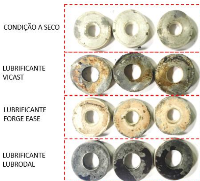
Figura 18 – Corpos de prova após o ensaio do anel
