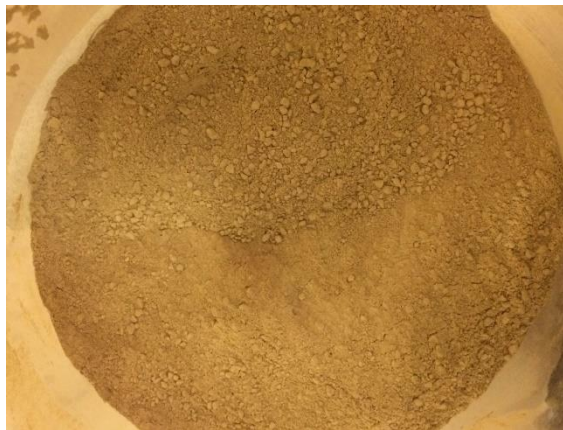
Figura 3.5: Rejeito de zinco seco e destorroado
