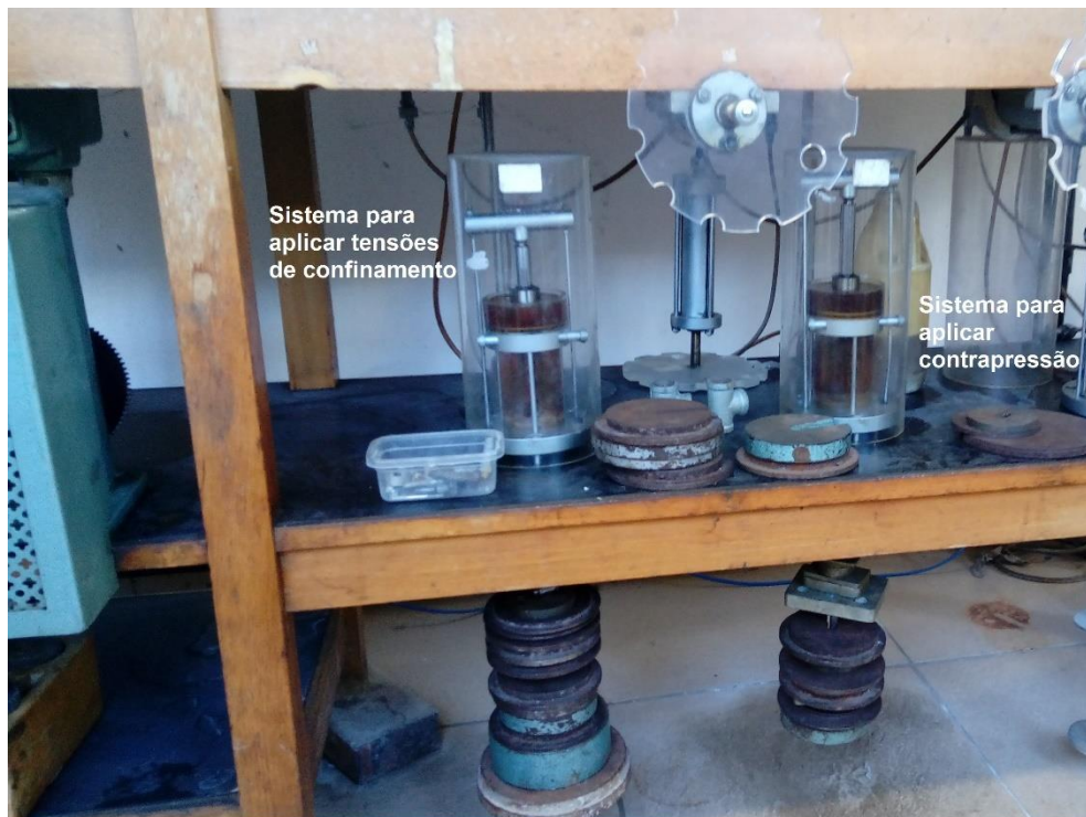
Figura 3.9: Sistema aplicador de tensões do Geonor
