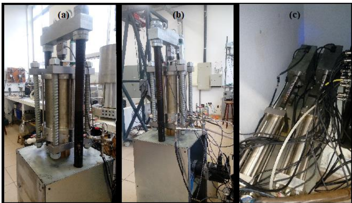
Figura 3.10: (a e b) Equipamento TriAp - LEGG/UFRGS. (c) GDSs do TriAp
