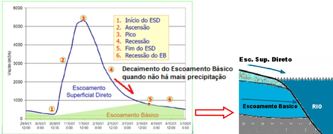
**Figura 3.** Comportamento do hidrograma perante a interação com a precipitação.
