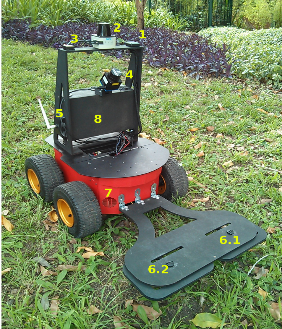
Figura 4.1: Robô Pioneer 3AT no qual foi baseada a disposição dos lasers.
