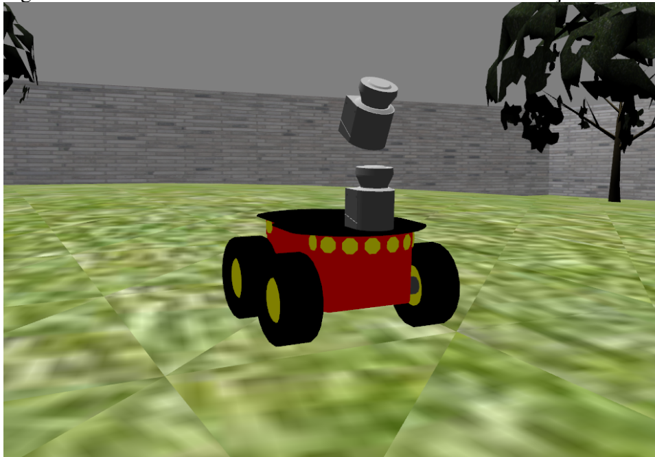
Figura 4.2: Robô Pioneer 3AT utilizado no ambiente de simulação Gazebo.
