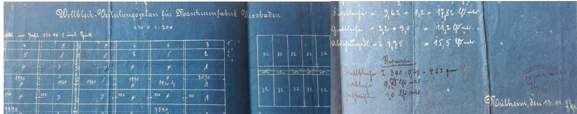
Figura 841: Planta de origem alemã: Wellblech-Verlegungsplan für Maschinenfabrik Wiesbaden (paginação da chapa metálica ondulada para a fábrica de máquinas em Wiesbaden) com cálculos das áreas de determinadas partes do prédio, assinada em Mülheim, 13.11.13. Fonte: Delfos-PUC, foto da autora 06.2017
