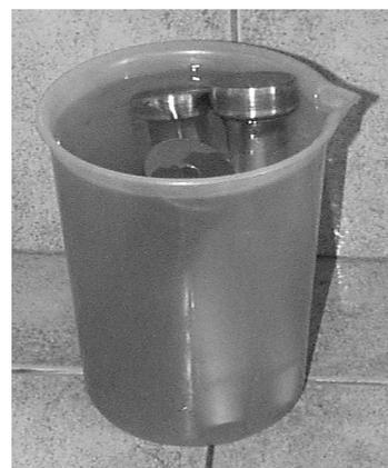
Figura 3.12 – Punções temperados e revenidos imersos em acetona para desengraxe.
