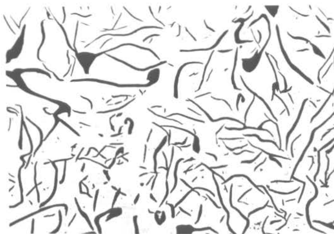
FIG. 23 Microestrutura no centro do corpo de prova de diâmetro de 35 mm. Sem ataque, grafitas em veios - 100x
