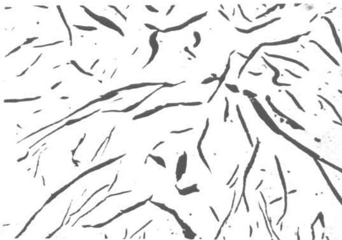
FIG. 19 Microestrutura no centro do corpo de prova de diâmetro de 50 mm.
