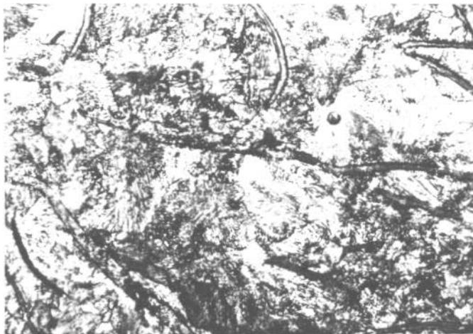
FIG 29 Microestrutura do corpo de prova de diâmetro de 20 mm, desmoldado a frio, com ataque (Nital 1%). Matriz perlítica - Aumento 500x.
