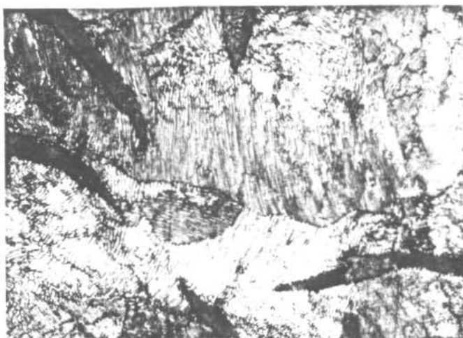
FIG. 21 Microestrutura do corpo de prova de diâmetro de 50 mm, desmoldado a frio, com ataque (Nital 1%). Matriz perlítica - Aumento 1000x.
