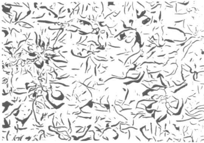
FIG 27 Metalografia próximo à borda do corpo de prova de diâmetro de 20 mm. Sem ataque, grafitas em veios - 100x
