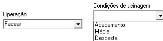
Figura 4.6 – Opções de condições de usinagem do S_ProcPlan .
