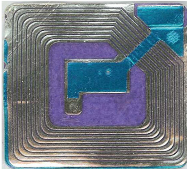
Figura 1.2: Fotografia de uma etiqueta para prevenção a roubo. Podemos ver claramente a antena em forma de bobina [6].
