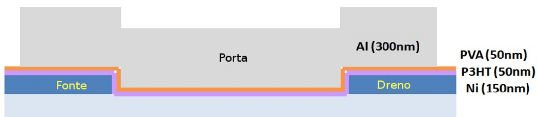
Figura 3.9: Esquema da vista lateral dos transistores, onde estão indicadas as espessuras dos filmes depositados.
