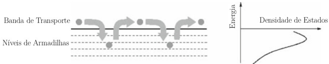
Figura 2.5: Princípio do modelo MTR. Adaptado de [8].
