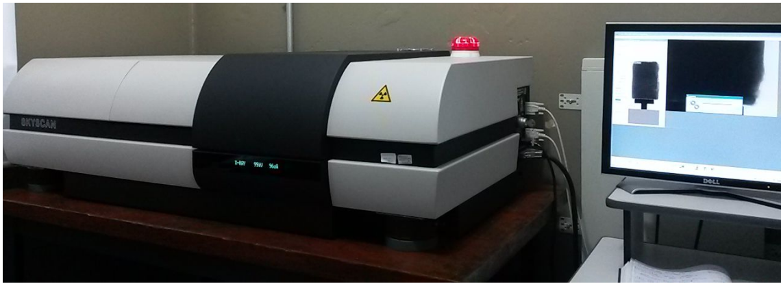
Figura 22. Microtomógrafo SkyScan 1172 utilizado para análise das amostras.
