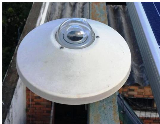
Figura 3.13 – Piranômetro fixado na bancada de ensaio.
