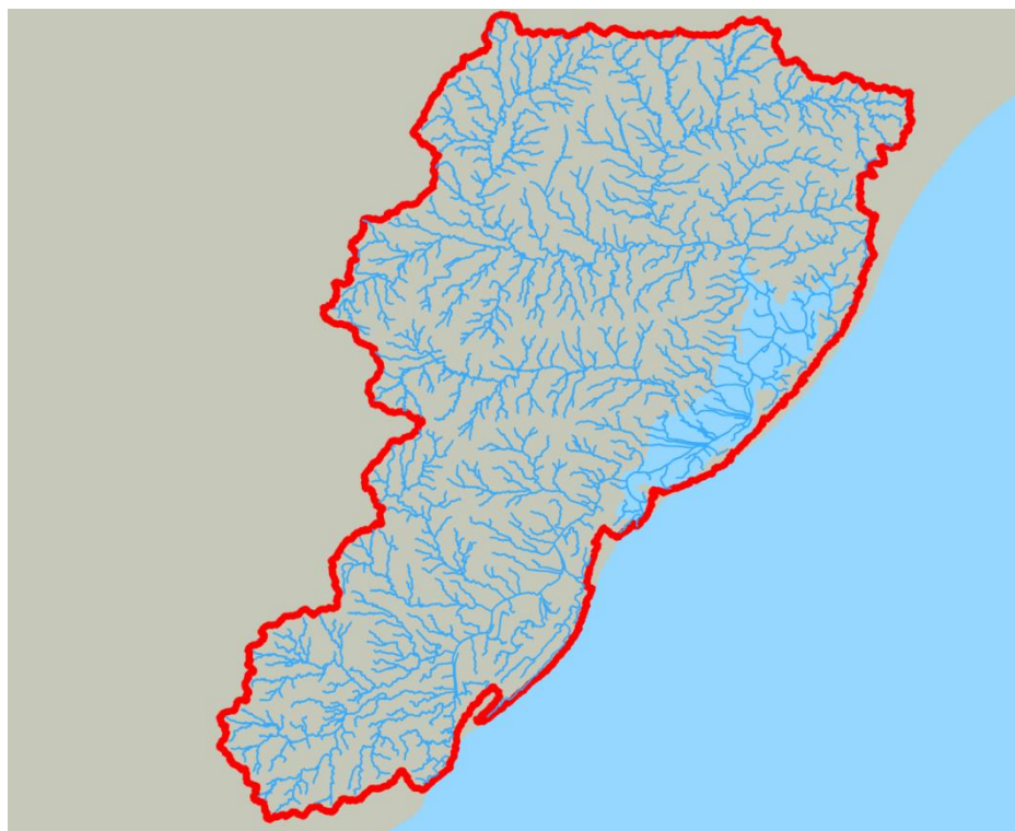
Figura 4.7 – Unidades de discretização do modelo hidrológico (trechos de drenagem)
