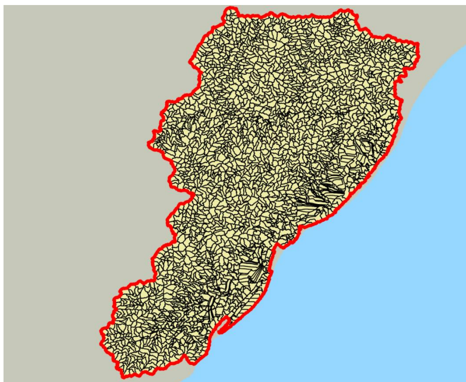
Figura 4.6 – Unidades de discretização do modelo hidrológico (minibacias)
