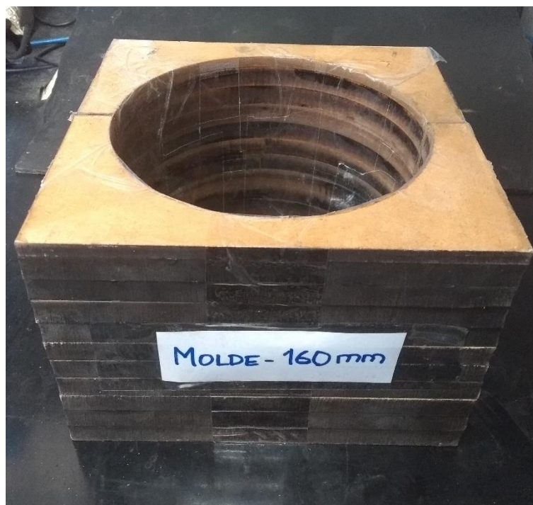
Figura 3.20: molde de madeira para moldagem da camada de reforço
