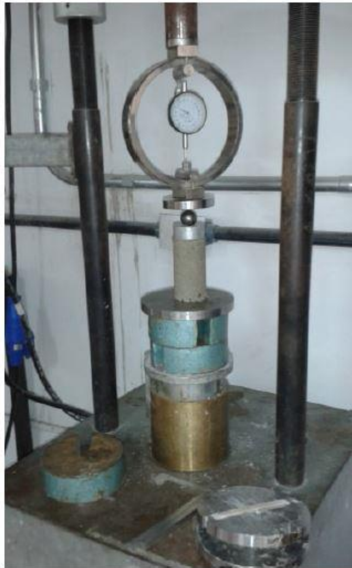
Figura 3.5: ensaio de compressão simples (FOPPA, 2016).
