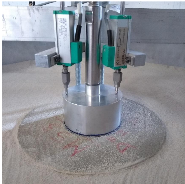
Figura 3.23: prova de carga pronta para o início do ensaio
