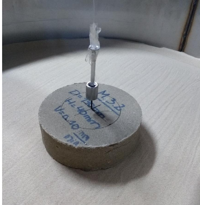
Figura 3.22: posicionamento da camada de reforço no interior do tanque
