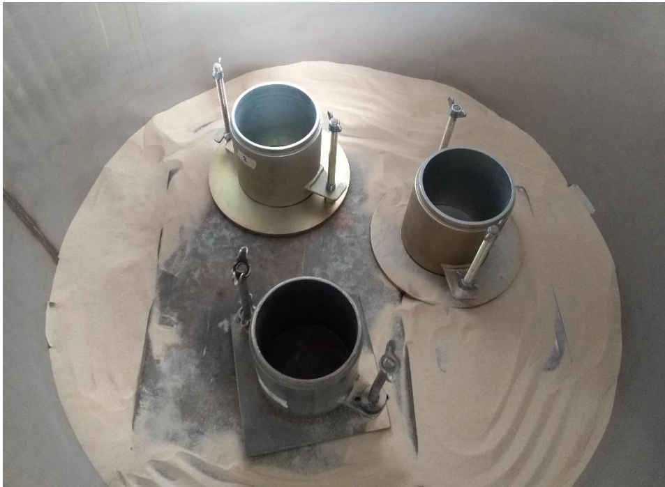
Figura 3.16: aferição da densidade relativa no tanque de solo
