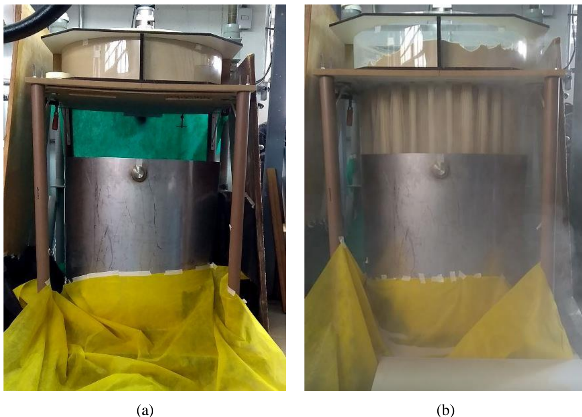
Figura 3.14:enchimento do tanque: (a) posicionamento do pluviador acima do tanque; (b) pluviação da areia
