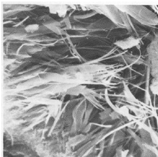
Figura 2.1: fotomicrografia da pasta de cimento Portland endurecida (INGLES e METCLAF, 1972).
