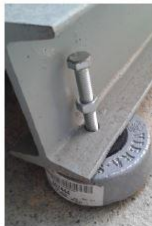
Figura 3.9: dispositivo para nivelamento e redução de vibração (Vibra-Stop) (FOPPA, 2016).
