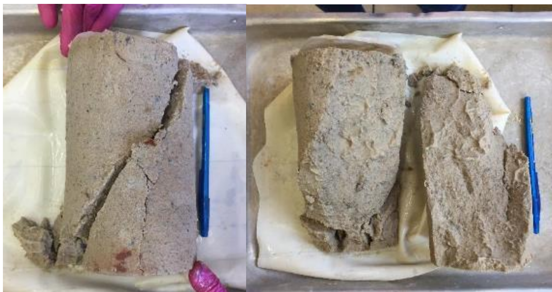
Figura 4.20: Corpo de prova 01( p'_{\text{inicial}} = 75 kPa).
