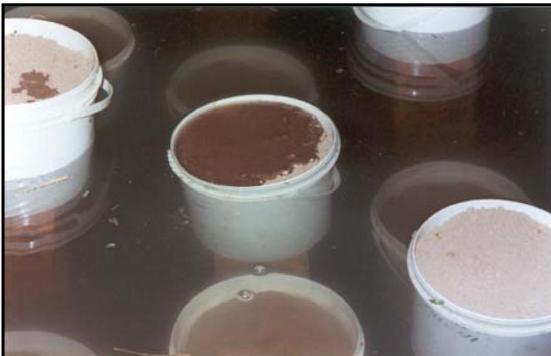
Figura 4 – Detalhe dos potes (4L) em diferentes profundidades de lâminas d’água, durante a montagem do experimento.
