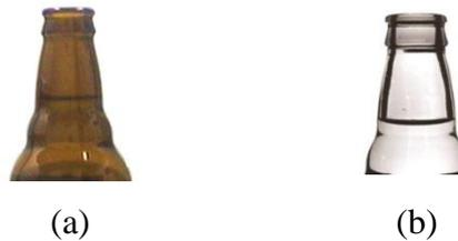
Figura 3.5 - Exemplo de imagens com iluminação direta (a) e iluminação traseira (b).
