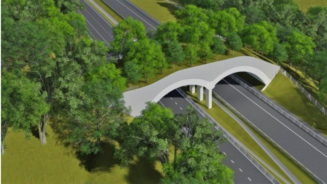
Figura 7 - Projeto do viaduto vegetado na BR 101 – RJ
