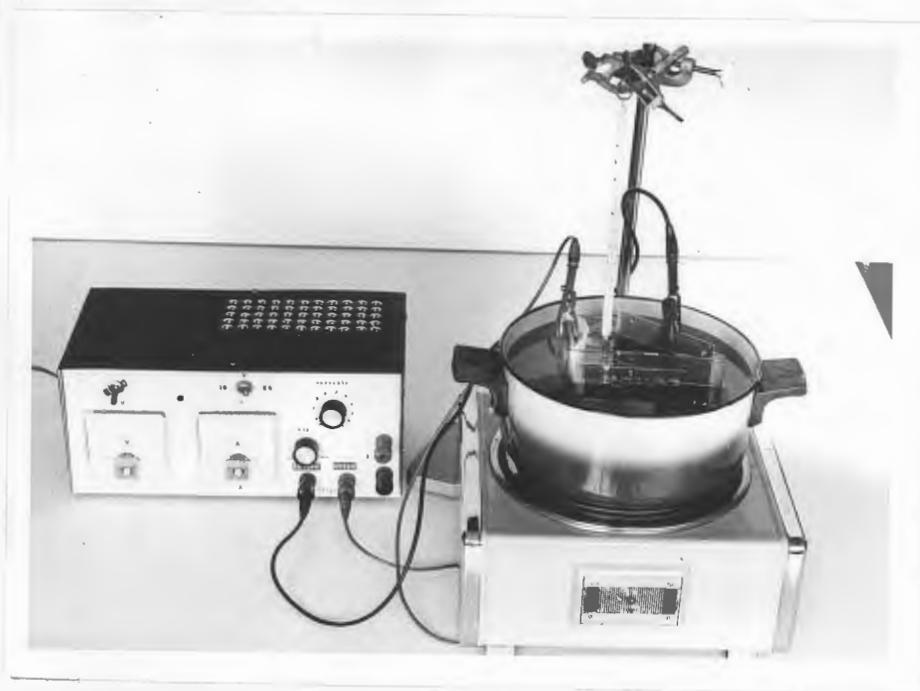
Fig. 3.2.3.1-2 Aparelhagem para Execução de ensaios na Célula de Hull.
