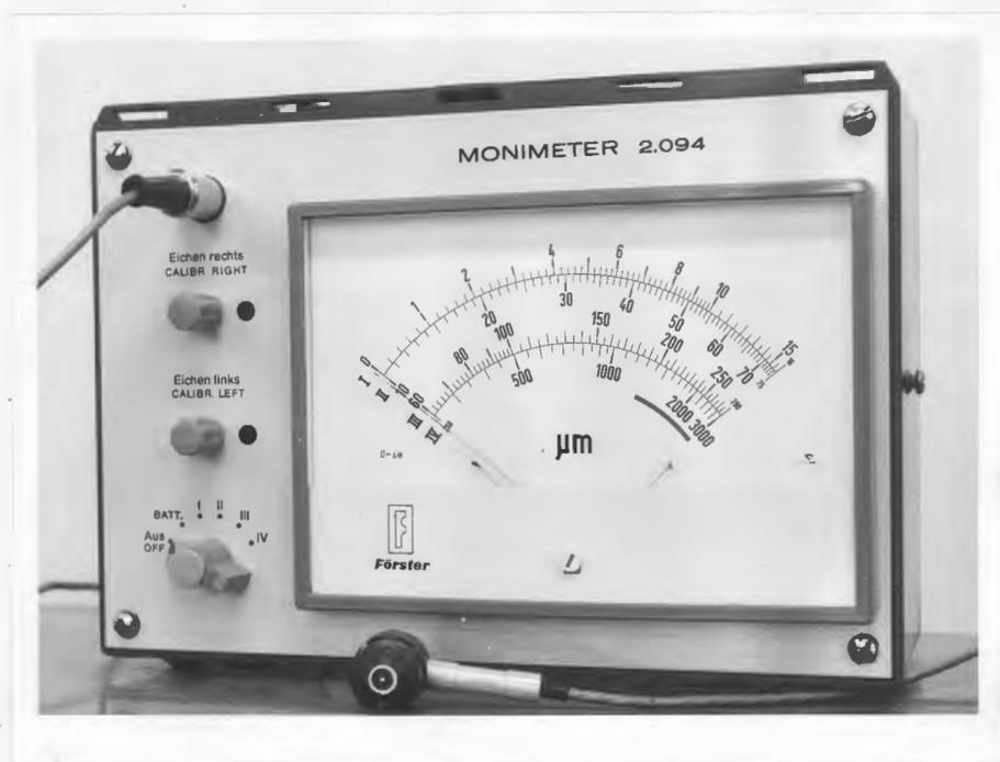
Fig. 3.2.4.1-1 Medidor de Espessura de Eletrodepósitos, por Método não Destrutivo.
