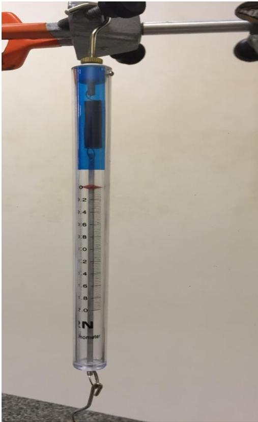
Figura 41 – Peso registrado no dinamômetro
