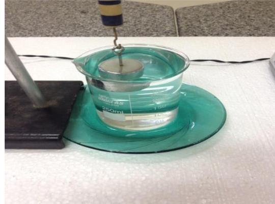
Legenda: a Figura 16 demonstra o peso do corpo mensurado pelo dinamômetro quando o corpo está em equilíbrio e imerso no ar. A Figura 17 demonstra a entrada do corpo na água e a respectiva elevação do nível da mesma, não chegando a derramar.
