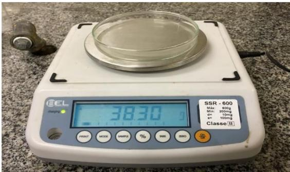
Figura 39 – Massa descontada (depois da tara)
