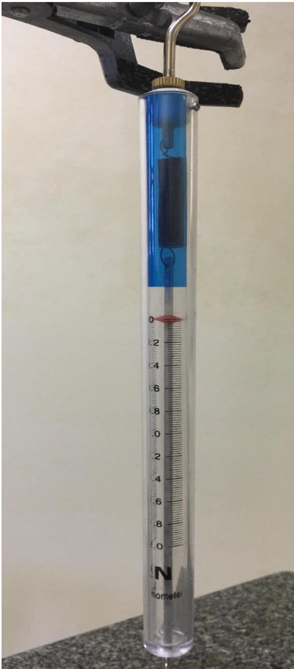
Figura 29 – Peso registrado no dinamômetro
