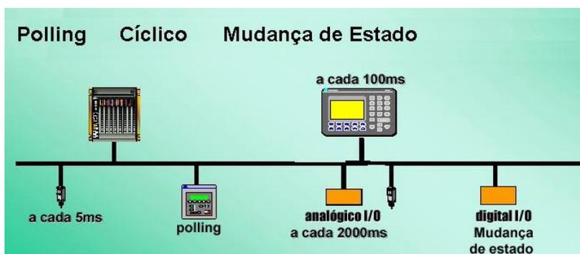
**Figura 3.5 – Rede *fieldbus* com três métodos de troca de dados.**
