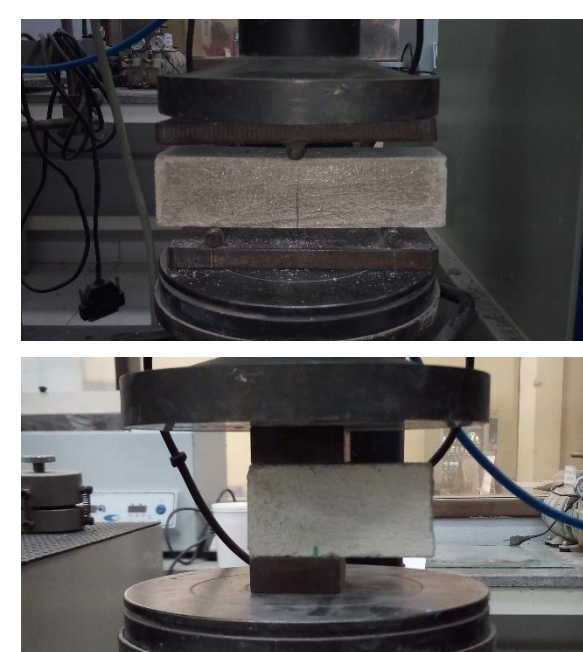
Figura 2: Resistência à compressão e à tração na flexão
