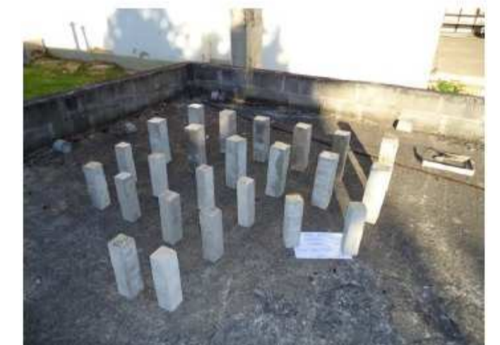
Figura 1: prismas de concreto expostos em Vitória - ES
